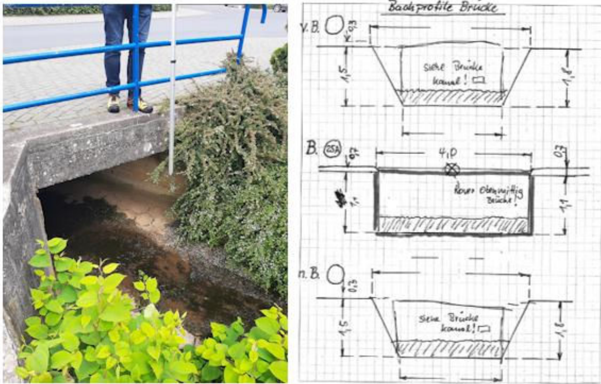
Abbildung 10: Aufnahme des Bachverlaufes mit Brücke und Aufmaßblatt (Beispiel)
