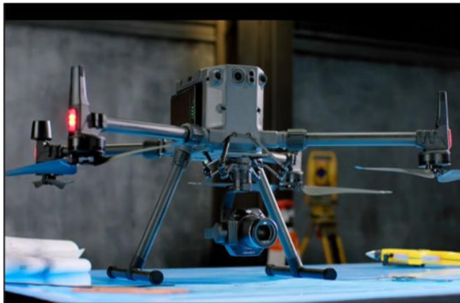
Abbildung 5: Vermessungsdrohne, Modell DJI M300 RTK
